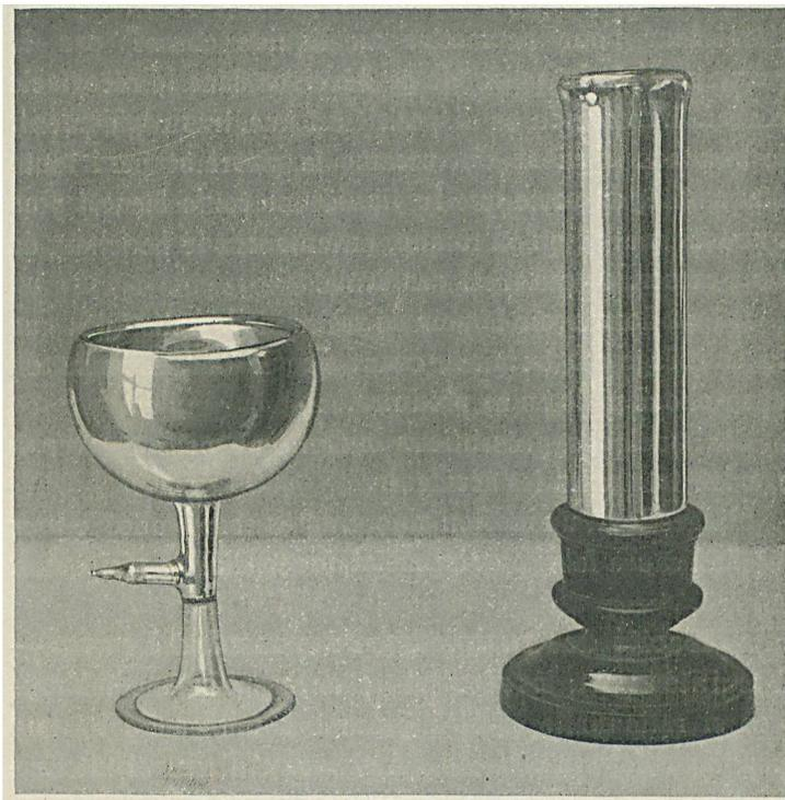
FIG. 19. — Disposition d'une éprouvette à vide sur un pied pour les manipulations; coupe pour les essais.
