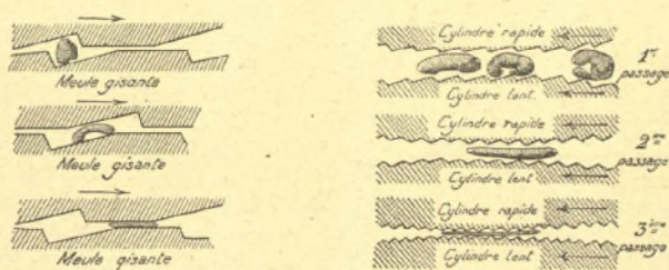
FIG. 15 et 16. — Action comparée des meules et des cylindres sur le grain.
