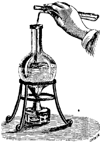
Fig. 81. — Réduction de la liqueur cupro-potassique par le sérum du lait.
