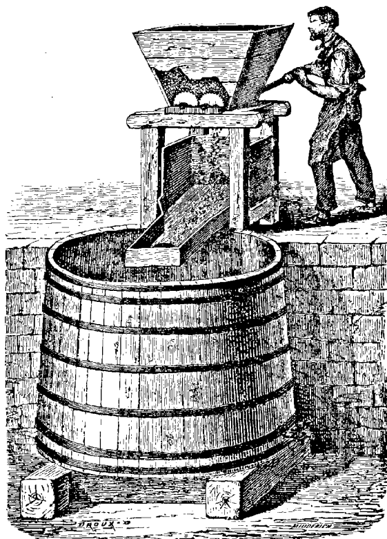
Fig. 166. — Rouleaux pour écraser le raisin, en usage dans le midi de la France.
