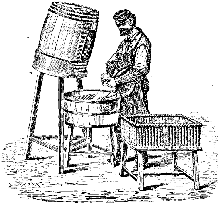
Fig. 176. — Le dégorgement d'une bouteille de vin de Champagne.
