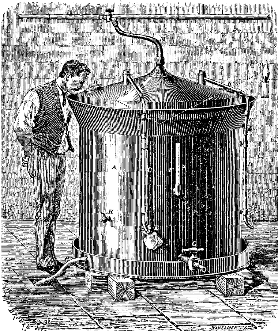
Fig. 214. — Premier appareil employé par M. Pasteur pour faire refroidir et fermenter le moût de bière.
