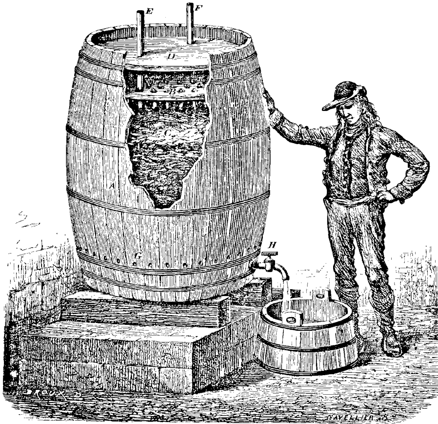
Fig. 255. — Le tonneau de Schutzenbach, ou appareil en usage en Allemagne, pour la fabrication rapide du vinaigre.
