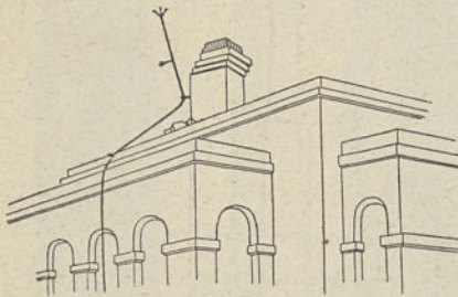
Fig. 213. — Descellement d'un paratonnerre à Jamalpur lors du tremblement de terre du 12 juin 1897 (d'après R. D. Oldham).
