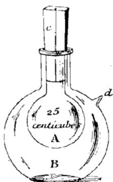
M. Boot représenté par la *fig. 5*, se compose d'une capacité en verre soufflé A, en forme de petit ballon, fermé par un bouchon C en verre rodé; sur le col du petit ballon est soudé un second ballon B enveloppant le premier. On a fait le vide dans l'espace intermédiaire en aspirant par la
