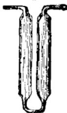
inégal ; l'un, qui porte un trait indicateur, est le plus gros ; il a un diamètre d'environ  $\frac{1}{2}$  millimètre, alors que l'autre n'a qu'un diamètre de  $\frac{1}{4}$  de millimètre. Le remplissage de ce pycnomètre se fait en plongeant l'extrémité du tube étroit dans le liquide, et en aspirant par un tube à boule adapté à l'extrémité du tube opposé.
