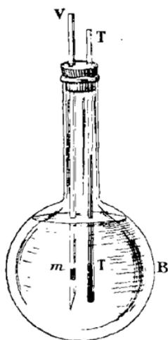
Après le refroidissement, on engage le tube V, ainsi qu'un thermomètre sensible T, dans un bouchon que l'on adapte au col d'un grand ballon B rempli d'eau distillée.
