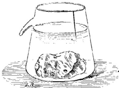
corps solide plongé dans l'eau. Il faut naturellement avoir soin que l'immersion soit parfaite et qu'il n'y ait aucune bulle d'air.
