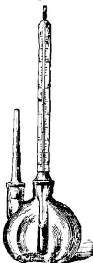
pipette à boule munie d'une poire à presser. La *fig. 2* représente un pycnomètre muni d'un thermomètre, le remplissage se fait par une tubulure latérale dont le bouchon creux laisse passer l'excès de liquide par son orifice capillaire.
