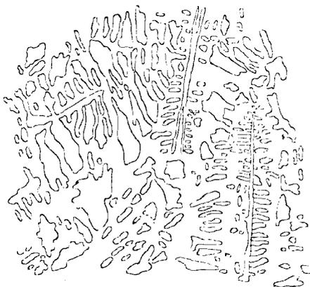
Fig. 78. — Échantillon de bronze à canons, à 10 p. 100 d'étain, calciné, puis décapé par l'acide sulfurique étendu (50 diam.).
