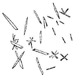
Fig. 21. — Fluosilicate de baryum cristallisé d'une solution chaude (60 diam.).
