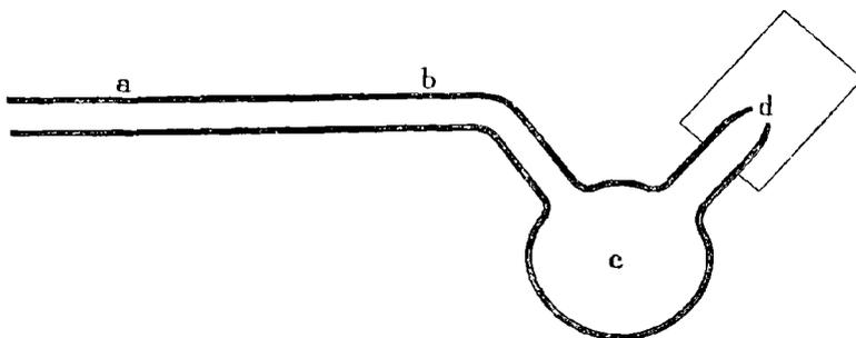
Fig. 80. — Tube à chloruration (grand. nat.). Largeur du tube, 3-5<sup>mm</sup>.
