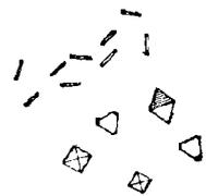
Fig. 50. — Flualuminate d'ammonium (130 diam.). Les cristaux prismatiques caractéristiques pour l'aluminium se produisent avec un excès de ce métal.
