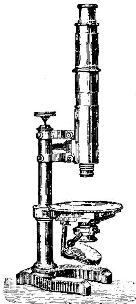
Fig. 1. — Microscope pour les recherches microchimiques.
