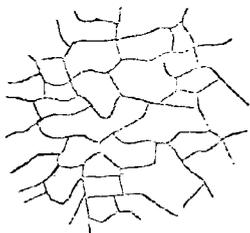
Fig. 79. — Cuivre avec 1 p. 100 d'argent; bouton aplati, décappé par l'acide azotique (40 diam.).
