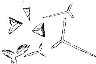
Fig. 83. — Acétate triple de glucinium, de sodium et d'uranyle (90 diam.).
