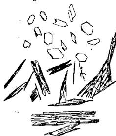
Fig. 28. — Chlorure de plomb. Les cristaux rhombiques ont été obtenus d'une solution dans l'acide chlorhydrique dilué; les cristaux prismatiques d'une solution dans l'eau chaude (60 diam.).
