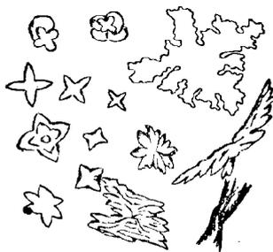
Fig. 34. — Chromate mercurieux précipité à chaud d'une solution acidulée, les gros cristaux à gauche avec excès de dichromate alcalin (130 diam.).
