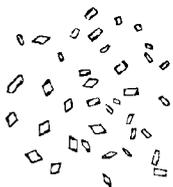
Fig. 30. — Sulfate de plomb cristallisé dans l'acide azotique (300 diam.).
