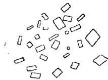
Fig. 72. — Sulfate de strontium cristallisé de sa solution dans l'acide chlorhydrique (200 diam.).
