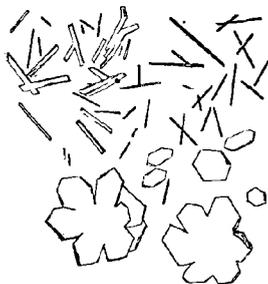
Fig. 54. — Niobate de sodium. Les grands cristaux hexagonaux n'apparaissent que d'une façon transitoire, et seulement en présence d'un excès de soude caustique (130 diam.).
