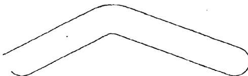
Fig. 69. — Tube pour purifier les liquides (eau, acides, etc.) par distillation (réduction de moitié).
