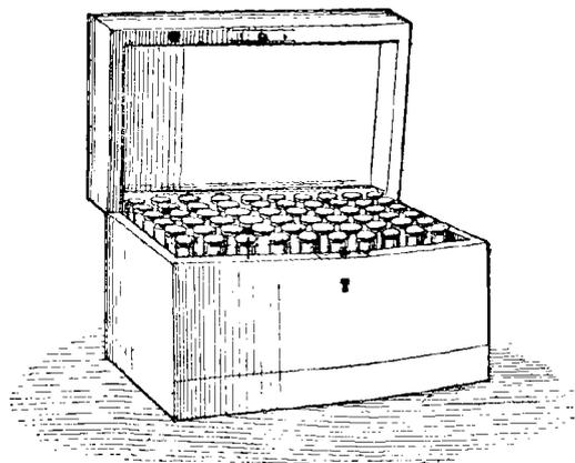
Fig. 2. — Boîte à réactifs pour l'analyse microchimique, construite sur les indications de M. Behrens. Dans le tiroir, sous la boîte, une petite pince à bouts de platine, un fil de platine emmanché, deux petites capsules de platine, etc.
