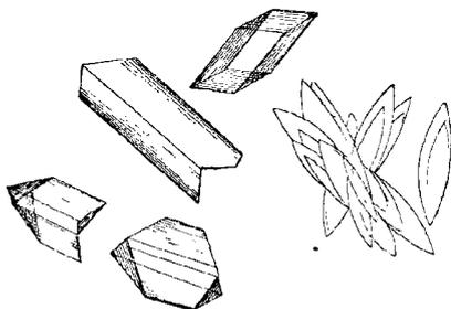
Fig. 11. — Oxalate double de potassium et de glucinium. Les gros cristaux prismatiques sont obtenus avec un excès d'oxalate de potassium, les paillettes lenticulaires à droite avec un excès de sel de glucinium (120 diam.).
