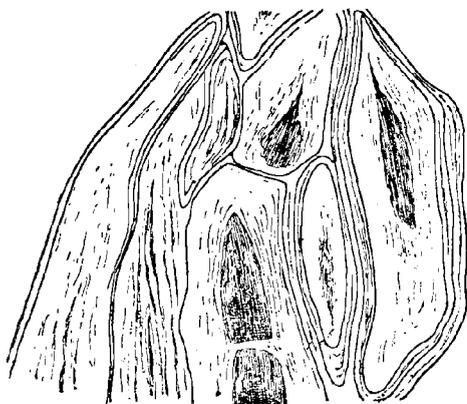
Fig. 73. — Serpentine jaune de Snarum (Norvège), attaquée par l'acide chlorhydrique et colorée par le vert malachite (60 diam.).
