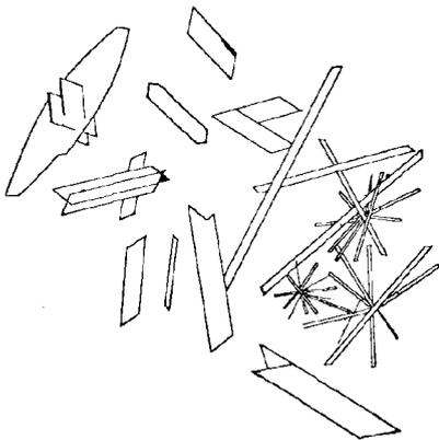
Fig. 25. — Sulfate de calcium (gypse) (200 diam.). Les aiguilles proviennent d'une solution contenant de l'acide chlorhydrique ; les cristaux courts et les maels d'une solution aiguisée par un peu d'acide acétique.
