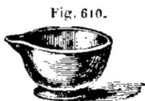
plus facile de le chauffer sans danger, et parce que les surfaces métalliques n'attirent pas l'humidité comme les surfaces vitreuses. L'intérieur du mortier doit être nettoyé, avant de s'en servir, au moyen d'un peu d'oxyde de cuivre que l'on y broie et qu'on rejette ensuite.
