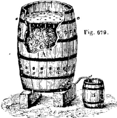
une cuvette dans laquelle on verse la liqueur alcoolique. Ce fond est percé d'un grand nombre de trous, que traversent des bouts de ficelle terminés par des nœuds pour qu'ils ne puissent pas tomber. La liqueur alcoolique s'infiltré le long des ficelles, et tombant en gouttes sur les copeaux, elle s'écoule en couche mince, et présente une large surface à l'action oxydante de l'air ; l'oxydation s'opère sous l'influence du
