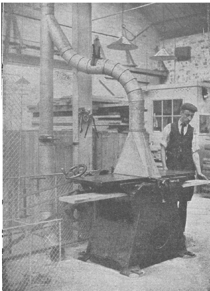
Fig. 65. — Aspiration des copeaux sur une raboteuse.
