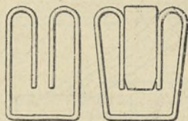
Fig. 71. — Contacts à paillettes à ressort.
