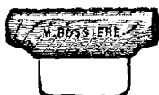
Fig. 58. — Glace à tige avec manche. Étire en glace servant à donner un lustre aux tiges de bottes, en dernière façon (Bossière).
