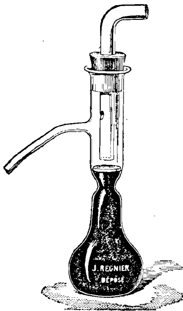
Fig. 2. — Régulateur de température pour étuve à fermentation.
