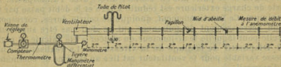
FIG. 117. — Montage prévu pour un essai d'aéro-ventilateur de 300.
