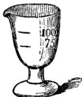
Jacquelain) portant deux traits au diamant, l'un à 75 centimètres cubes, l'autre à 100 centimètres cubes, on laisse tomber une pipette ou 10 centimètres cubes d'acide titré. On ajoute de l'eau distillée jusqu'au trait de 100 centimètres
