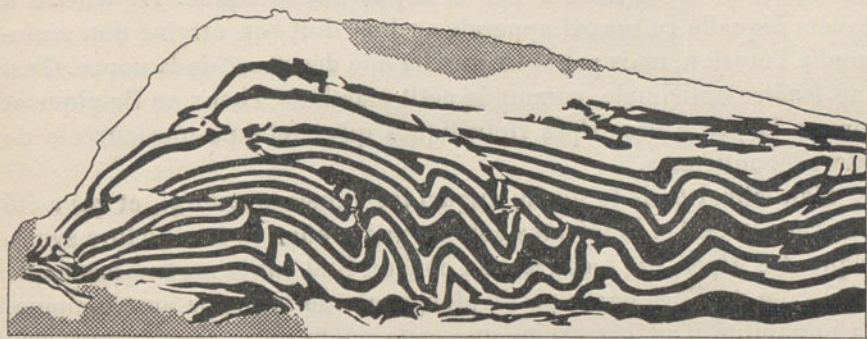
FIG. 344. — Charriages en miniature, d'après une expérience de Bailey Willis ( U. S. Geol. Survey, 13th Ann. Rept., 1891'92, pt. II, pl. XCVI, fig. b. )
