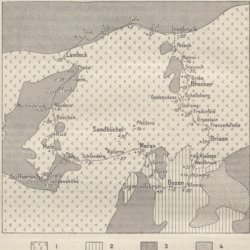
FIG. 393. — Déterminations de la pesanteur faites autour du massif de l'Oetzthal (Alpes Autrichiennes), d'après F. R. Helmert ( Die Schwerkraft im Hochgebirge, insbesondere in den Tyroler Alpen . In-8°, Berlin, 1890, pl. 1).
