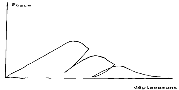
Fig. 8. - Essais de flexion 3 points avec chargement-déchargement pour le marbre.
