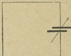
Fig. 6. — Circuit oscillant composé d'un cadre et d'un condensateur variable.
