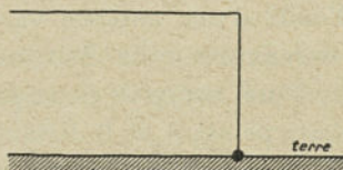
Fig. 7. — L'antenne est un vaste cadre ouvert.
