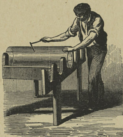
Ouvrier fendant le manchon.
