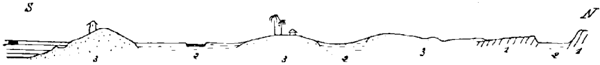
Fig. 22. — Cordons littoraux successifs entre Ouidah-plage et Ouidah. 1. Terre de barre ; 2. Argile (lagunes) ; 3. Sable (cordons littoraux).
