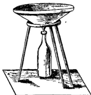
Fig. 63. — Entonnoir en zinc où l'on dépose le chlorure de calcium, en dessous le vase qui reçoit le chlorure après dissolution.
