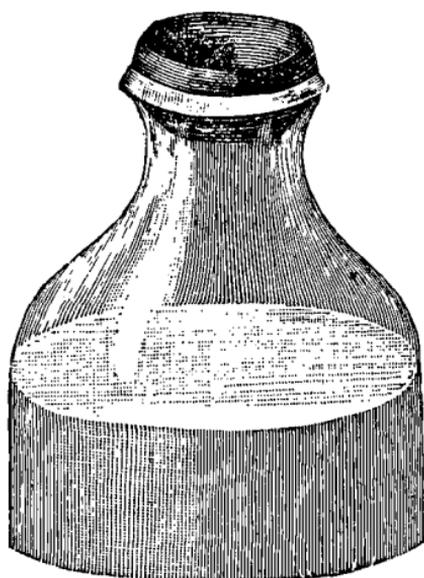
Fig. 31.—Appareil de Soxhlet.—Partie supérieure d'une bouteille, ouverture évasée sur laquelle on a placé un disque en caoutchouc.
