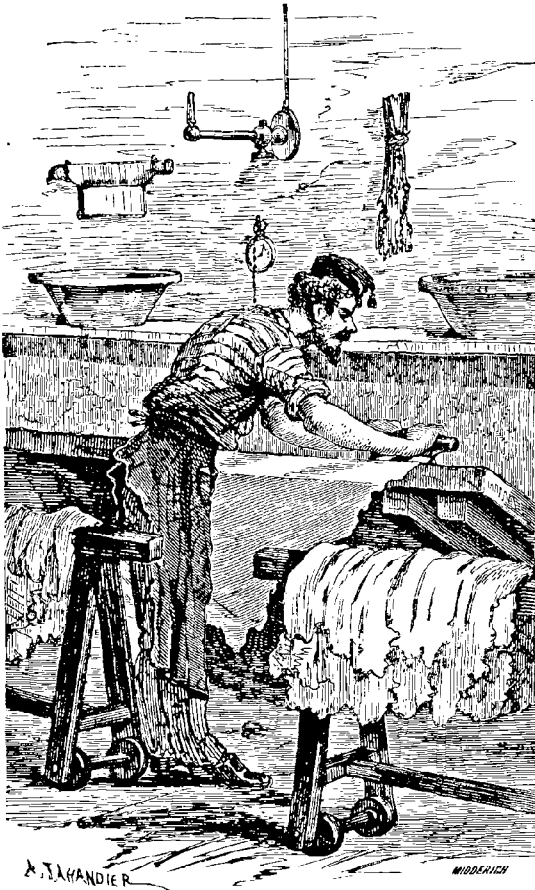
Fig. 213. — Mise en huile des peaux de chèvre et de mouton après la teinture.
