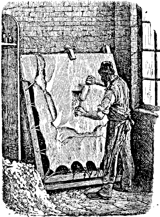
Fig. 217. — Raturage des peaux libres sur la herse du parcheminier.
