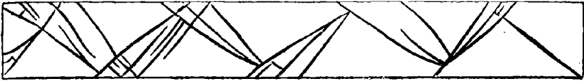
Fig. 59. — Effets de la torsion sur une plaque de verre épais (d'après M. Daubree).
