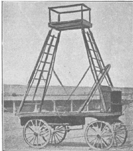
Fig. 162. — Voiture à plate-forme démontable pour la visite et l'entretien des conducteurs aériens.
