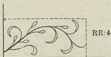
Fig. 183. — Empoutage suivi. Dessin avec rapport de répétition.
