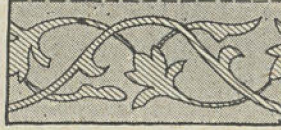
Fig. 211. — Empoutage suivi 2 couleurs. Planche à 2 corps.
