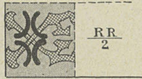
Fig. 214. — Empoutage à pointe 3 couleurs. Dessin.
