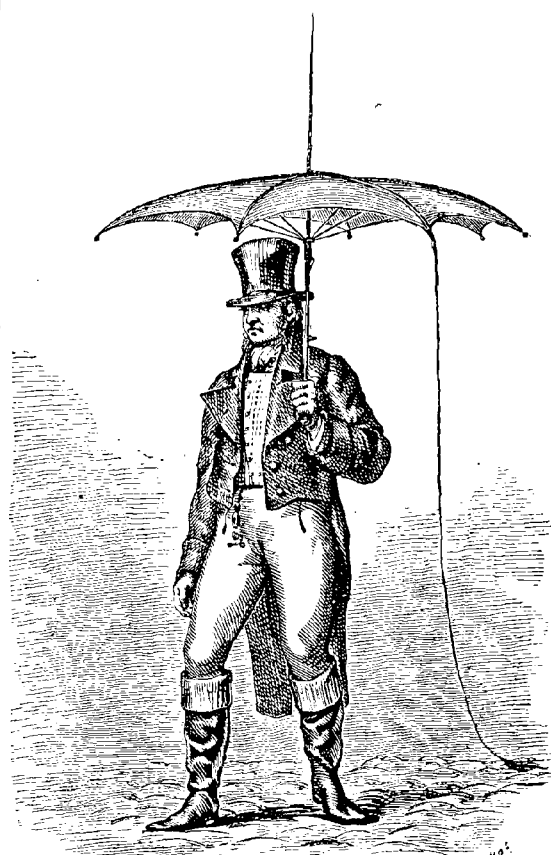
Fig. 314. — Le paratonnerre portatif, ou le parapluie-paratonnerre de Barbeu-Dubourg.
