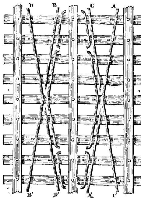
Fig. 183. — Appareil de coupement de voie.
