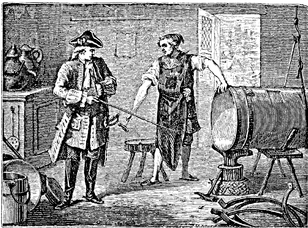
Fig. 81. — Le marquis de Jouffroy fait fabriquer au marteau, le cylindre de sa machine à vapeur, par le chaudronnier de Baume-les-Dames (page 162).
