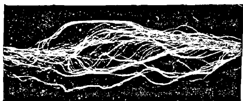
Fig. 342. — Etincelle en écheveau obtenue avec l'interrupteur Wehnelt (110 volts et 7 ampères).
