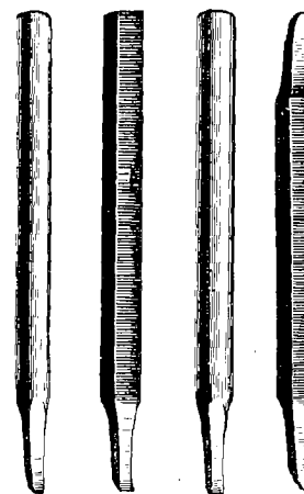
Fig. 792. Outils en acier fondu pour machines à mortaiser.
