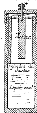
Etui en ébène. Fig. 282. — Pile de poche.
