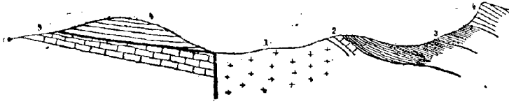
Fig. 400. — Coupe du jurassique au sud de Vorges (d'après M. Bertrand). — 1, marnes irisées ; 2, intralias et calcaire à gryphées ; 3, lias ; 4, bajocien ; 9, corallien.
