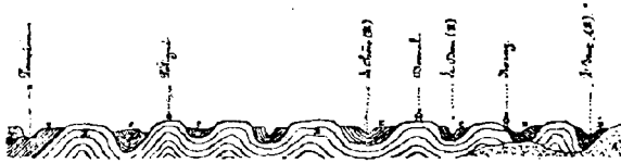
Fig. 257. — Plissements des terrains de transition entre Rennes et Nantes. — A, granite; B, grès; C, D, schistes.
