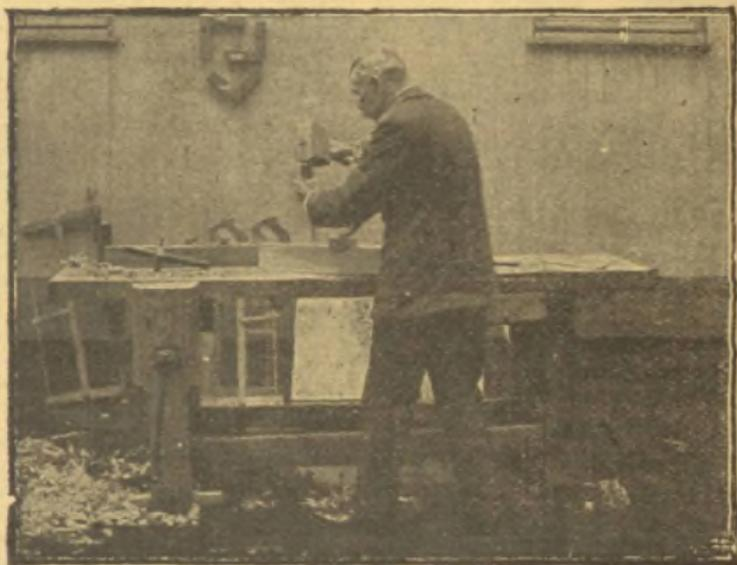
Fig. 155 bis. — Exécution d'une mortaise.
