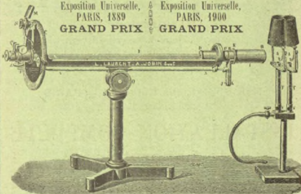
Figure réduite du polarimètre à lumière jaune.
