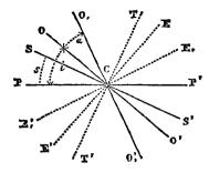
polarisation, OO' la section principale de la première lame O, O', celle de la seconde, SS' la section princip le du rhomboïde; EE', E, E', T T' des plans respectivement perpendiculaires aux trois premiers: je représente par i l'angle OCP que la première lame fait avec le plan primitif de polarisation, par a l'angle  $OCO_i$ , que la section principale de la seconde lame fait avec celle de la première, et par s l'angle PCS de la section principale du rhomboïde avec le plan primitif.
