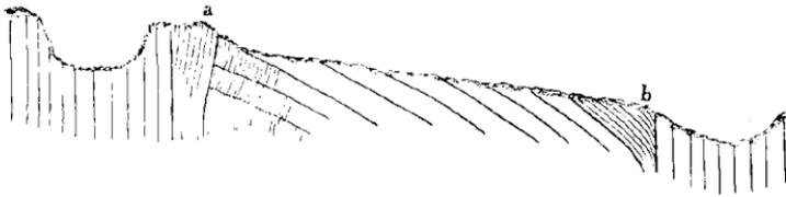
présente des traces de glissement remarquables. Il en est de même de la partie **a** de la même coupe. En **a**, les bancs inférieurs sont à l'état de blocs à surface irrégulière, souvent veinés de lames de calcite; un banc est même par endroits entièrement spathique; les calschistes de ce niveau ondulent légèrement.
