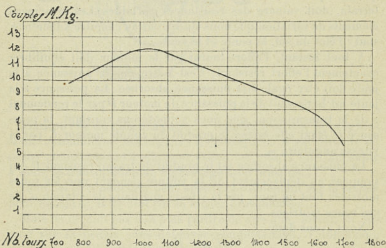
FIG. 47. — Essais d'un moteur Panhard 4 cylindres 90 × 120.
