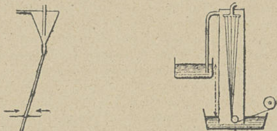
Fig. 19 et 20. — Schémas des dispositifs Thiele pour créer une dépression autour du fil sortant des filières.
