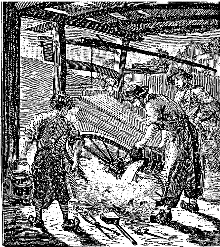
Pour cercler une roue de voiture, le charron chauffe un cercle (page 432).
