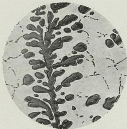
PHOT. 309. — Cuivre et oxydure de cuivre, sans eutectique.
