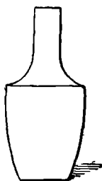
Fig. 39. — Mandrin de bois pour façonner les creusets de platine.
