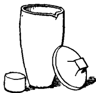
Fig. 94. — Creuset de terre de Paris avec son couvercle et son fromage. Environ 1/3 grandeur.
