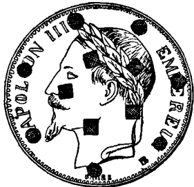
Fig. 18.—Echantillonnage d'une pièce de 5 francs en argent. (Grandeur).
