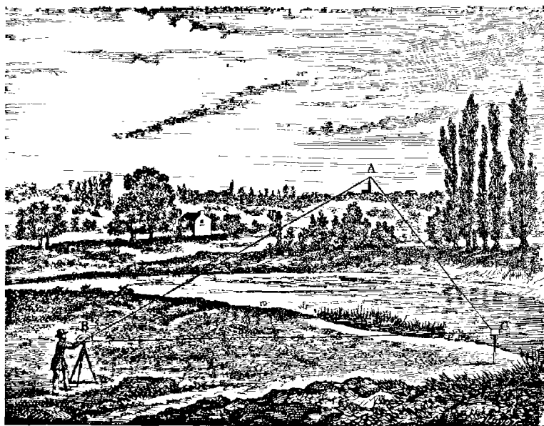
Fig. 215. — Mesure de la distance qui sépare un point d'un autre point inaccessible.
