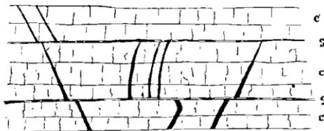
C. Calcaire, S. minces veines schisteuses, les filonnets de calcite sont représentés par les traits noirs, voisins de la verticale.
