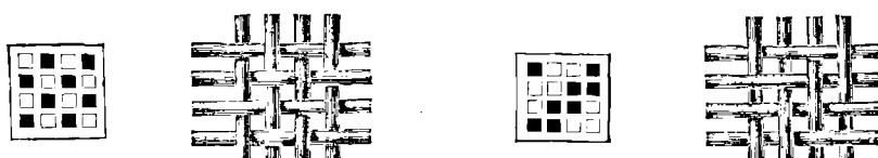
Fig. 227. — Armure-toile avec sa mise en carte.
