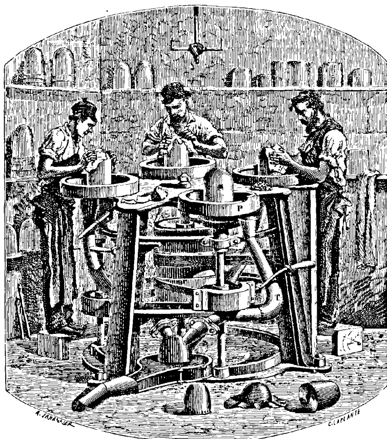
Fig. 255. — Ponçage des chapeaux de feutre.
