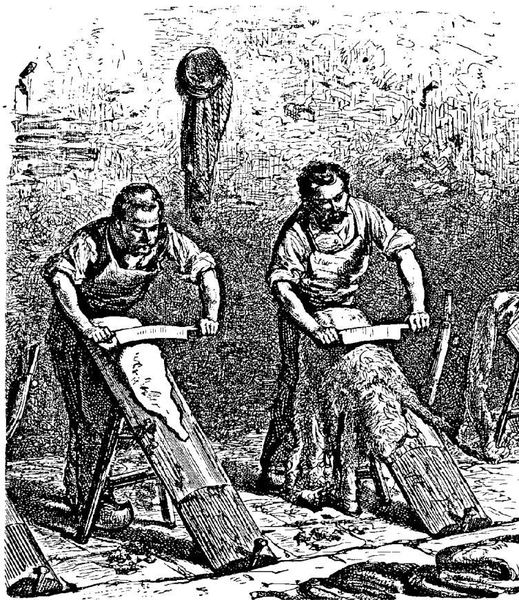
Fig. 257. — Travail des peaux sur le chevalet.
