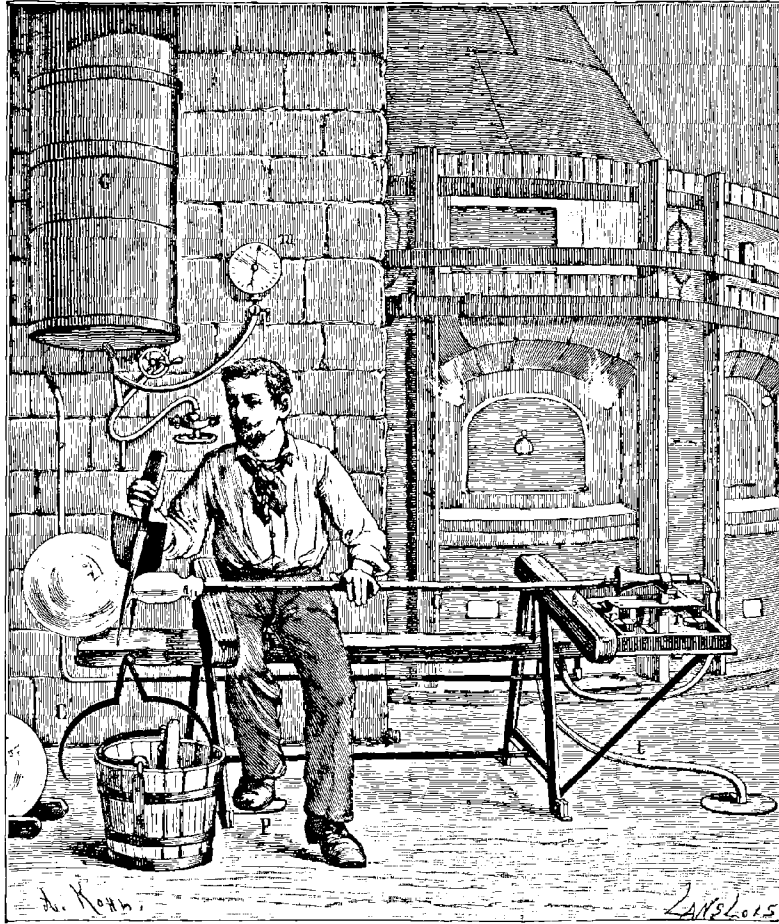
Fig. 343. — Soufflage à l'air comprimé (sur banc).
