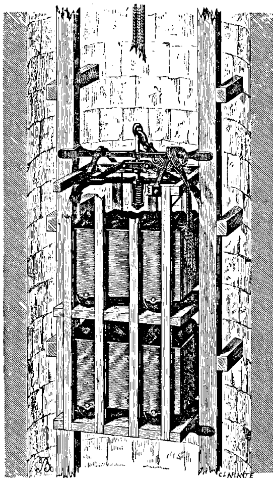
Fig. 34. — Parachute Fontaine après la rupture du câble.
