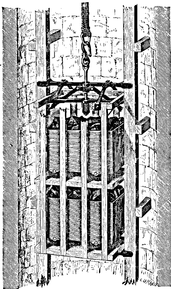
Fig. 33. — Parachute Fontaine avant la rupture du câble.
