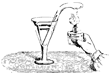
Fig. 224. — Absorption de l'oxygène de l'air par le phosphore à chaud.
