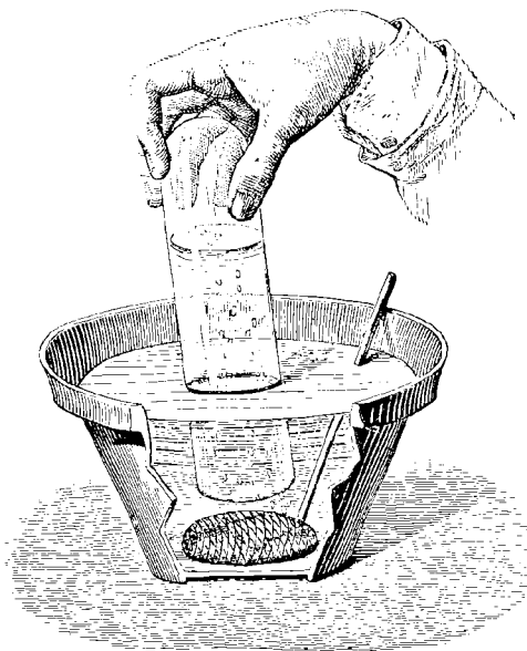
Fig. 172. — Préparation de l'hydrogène par le sodium.
